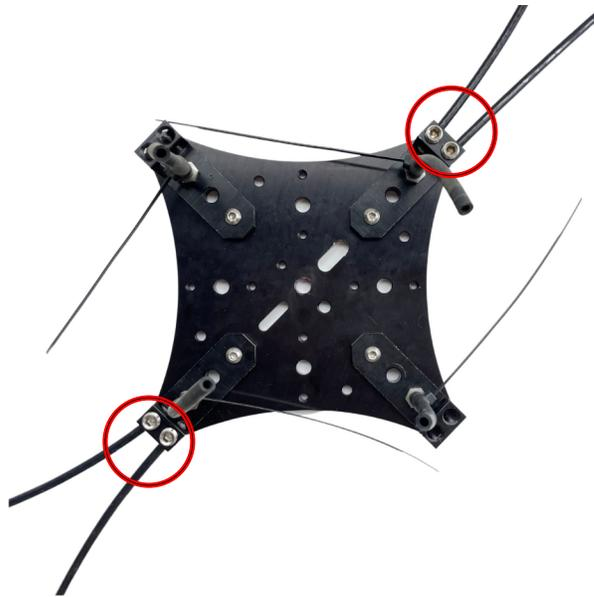
**INSERT AND FINGER TIGHTEN 4 CABLES INTO THE PLATE WITH THE TUBES ATTACHED.**
